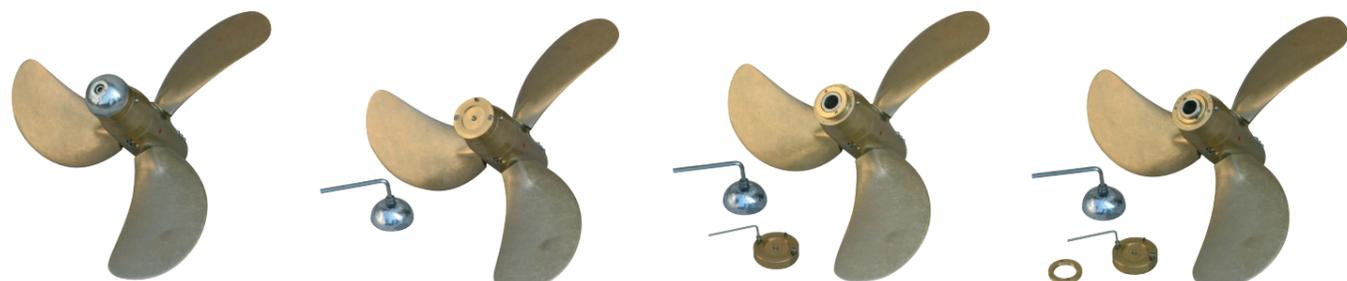
**Semplici operazioni di smontaggio dello zinco e delle ghiera di sicurezza necessarie per la regolazione del passo.**
